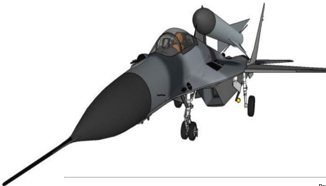
Powyżej: Przykładowa konfiguracja samolotu MiG-29 z rakietą S-75 do wynoszenia satelitów na niską orbitę okołozemską
