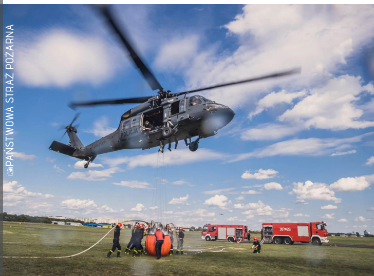
Napełnianie zbiornika typu Bambi Bucket podwieszanego pod śmigłowcem policyjnym S-70i Black Hawk International
