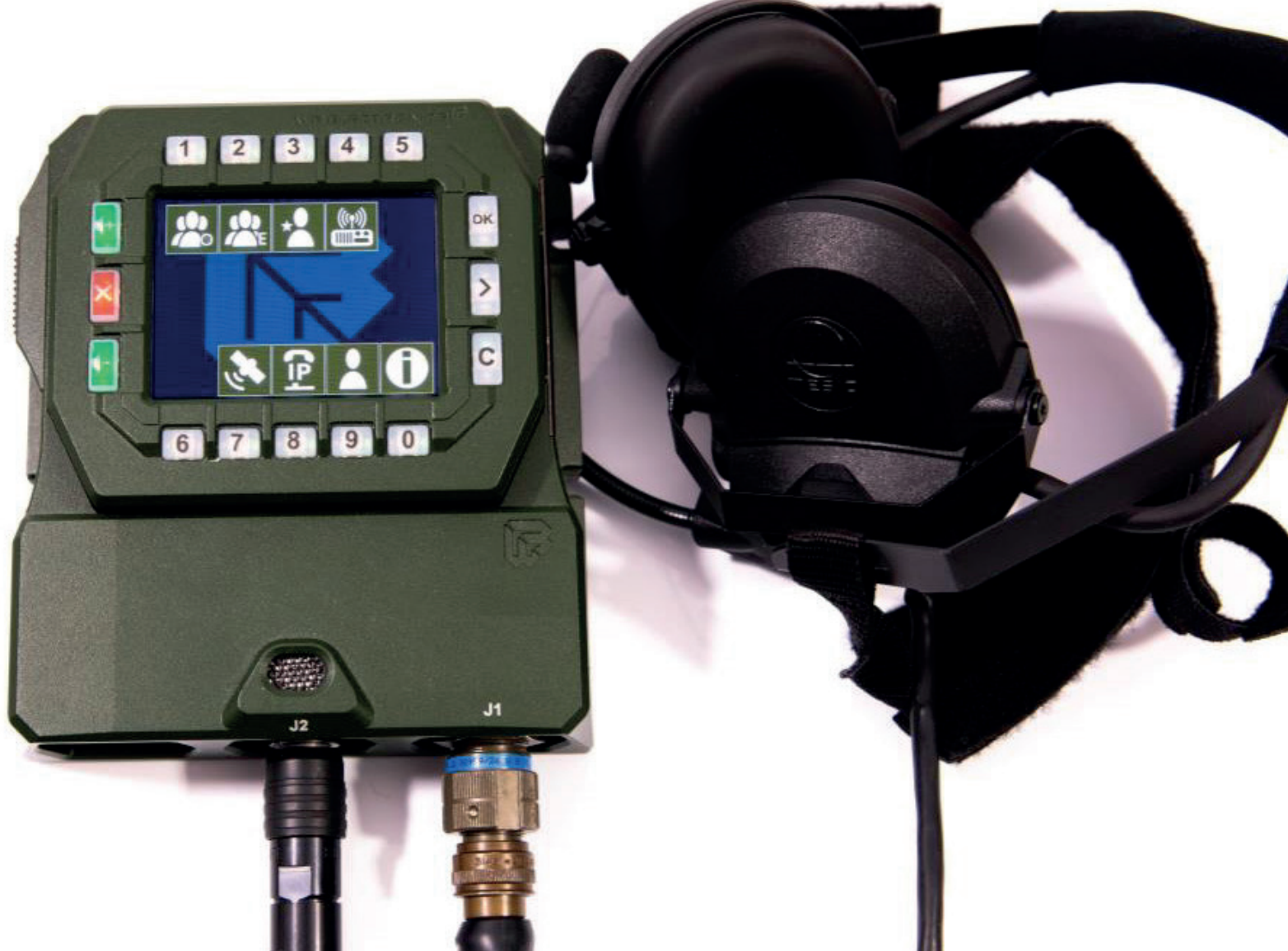
Powyżej: pulpit użytkownika systemu FONET z jednym wyświetlaczem Poniżej: pulpit użytkownika systemu FONET z dwoma wyświetlaczami umożliwiający łączność w systemie wieloklauzulowym
