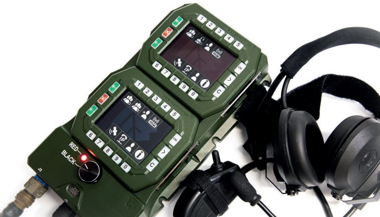
Powyżej: pulpit użytkownika systemu FONET z jednym wyświetlaczem Poniżej: pulpit użytkownika systemu FONET z dwoma wyświetlaczami umożliwiający łączność w systemie wieloklauzulowym
