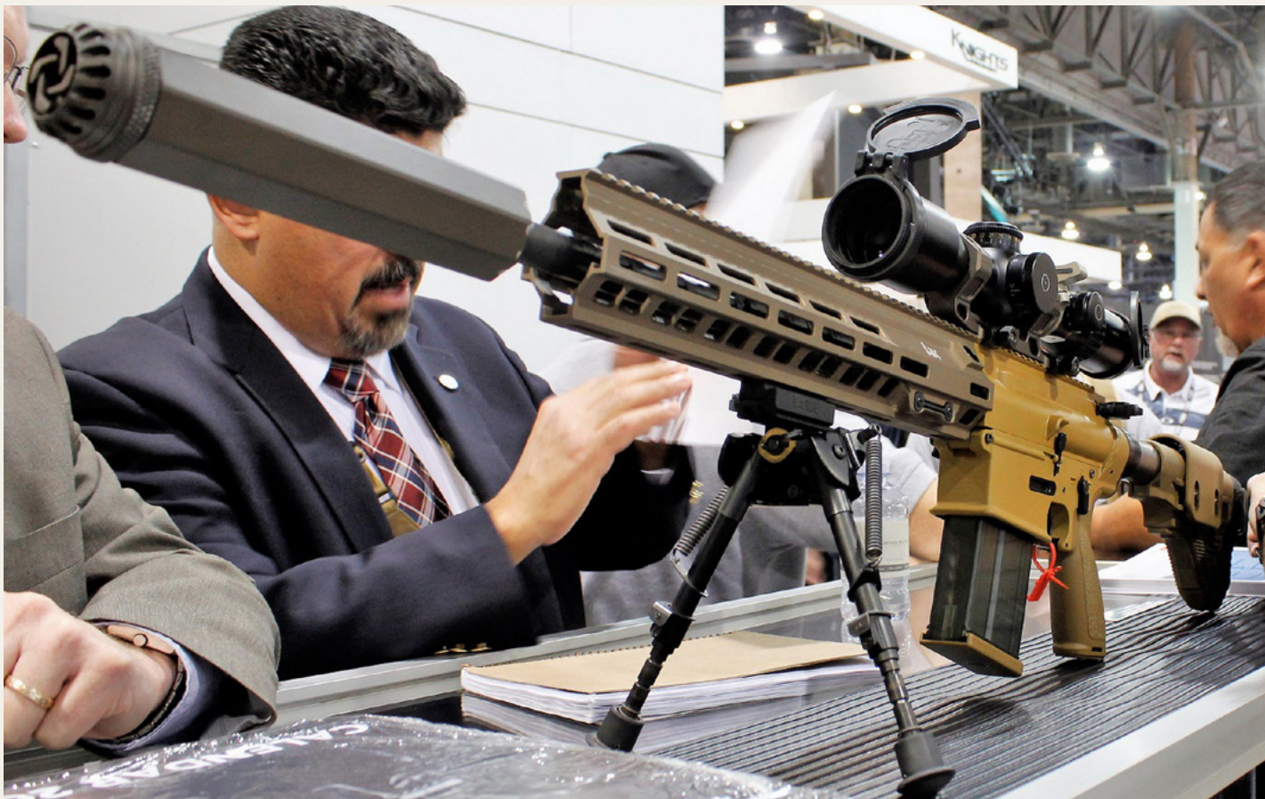
Wybrany przez US Army samopowtarzalny karabin wyborowy produkcji Heckler & Koch to zmodyfikowana, lżejsza odmiana G28, który z kolei jest precyzyjną wersją automatycznego HK417
