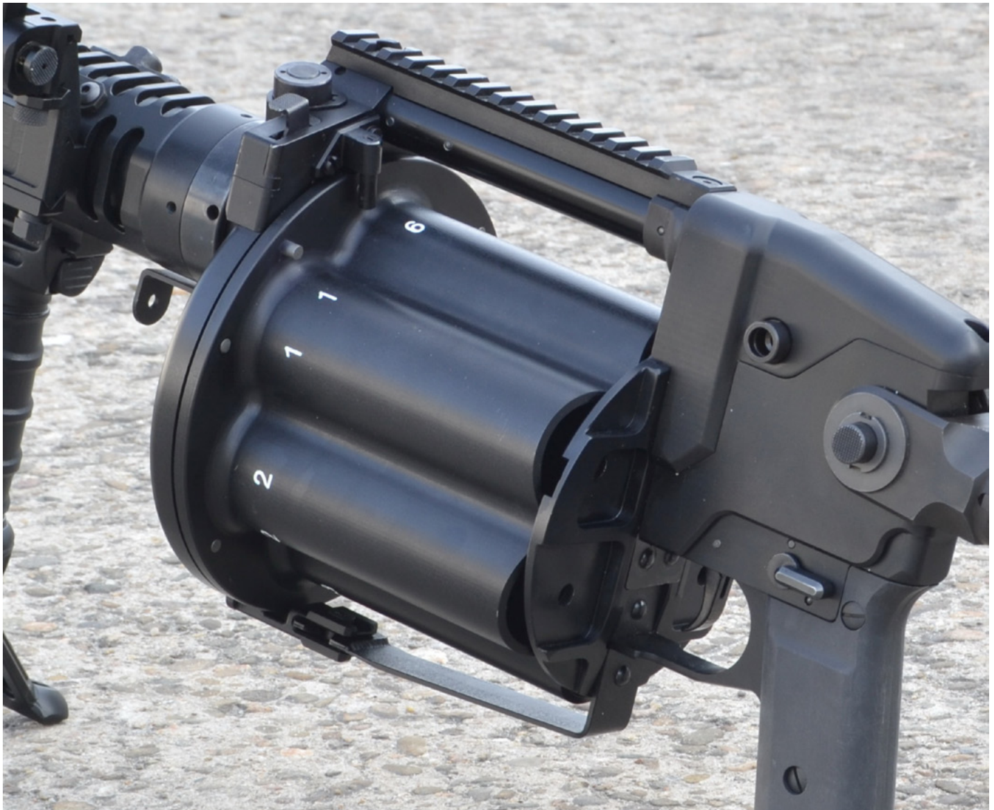
Zbliżenie na 6-nabojowy bęben granatnika rewolwerowego z naniesionymi oznaczeniami komór
