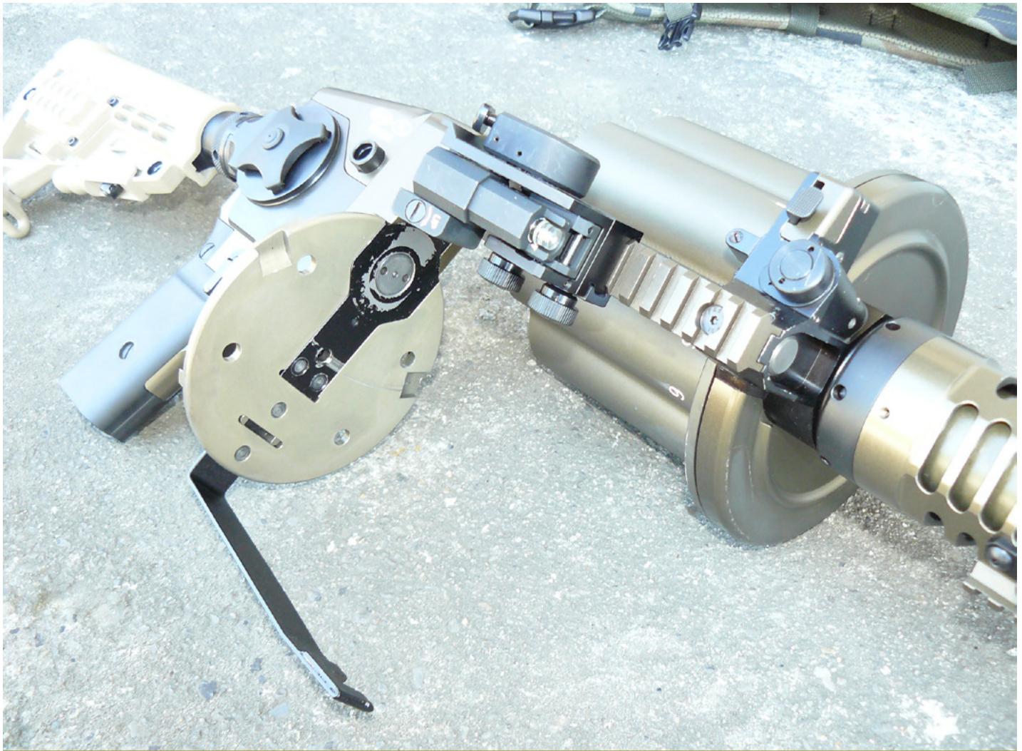
RGP-40 z partii próbnej otwarty z korpusem tylnym ze stopu tytanu Ti6Al4V. Miał moletowaną dźwignię ręcznego zwalniania bębna i zmniejszone punkty mocowania pasa nośnego
