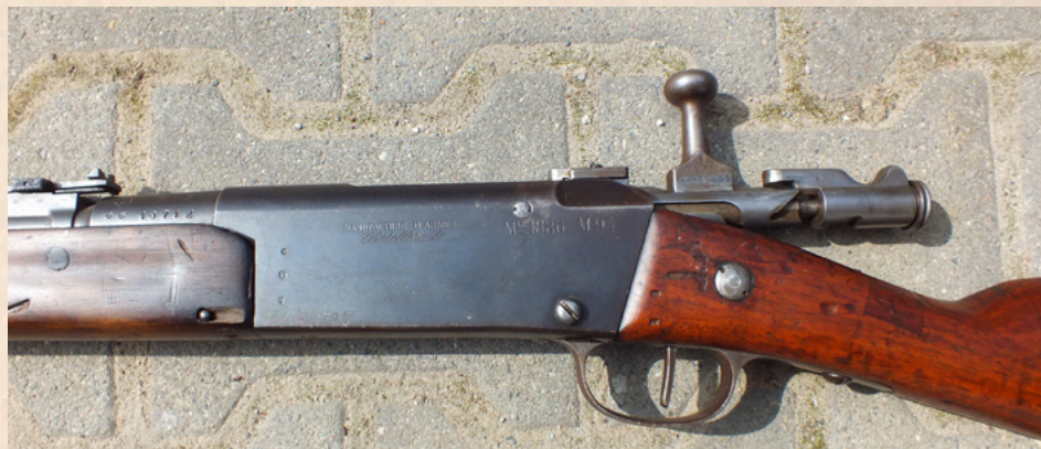
Karabin Lebel łatwo rozpoznać po charakterystycznej dużej komorze zamkowej, która kryje nie tylko zamek, ale też duży podajnik magazynka rurowego, znajdującego się pod lufą
