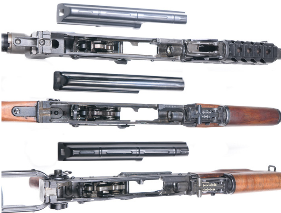
Wnętrza komór zamkowych (od góry): Hellpup, AKGN i AKMS. Komercyjny karabinek jest najbardziej uproszczony, ale też od podstaw powstawał na rynek cywilny
