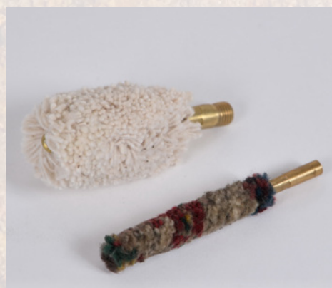
Końcówki bawełniane – odpowiednio do kalibrów 7,62 mm i 12 (ta ostatnia świetnie się sprawdza przy czyszczeniu przewodu gazowego kbk AK)
