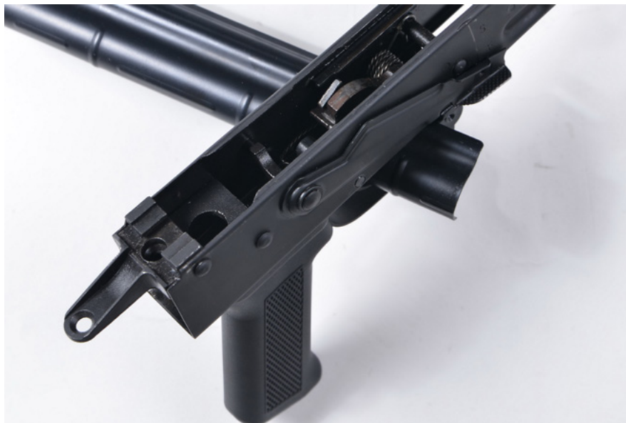
Tylna część komory zamkowej testowanej broni z obsadą kolby do Tantal
