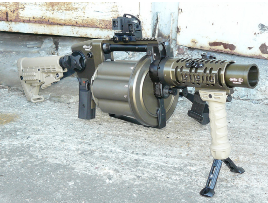
RGP-40 z partii próbnej. W jednym z dwóch granatników zastosowano elementy ze stopu tytanu, w drugim wykonano wiele podebrań i wyjęć, aby zmniejszyć masę
