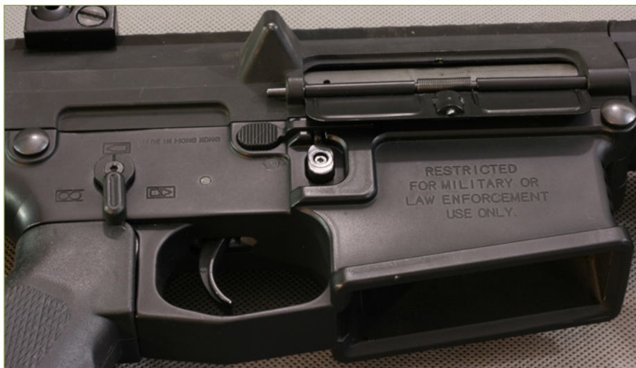
Komora zamkowa (korpus) repliki z prawej strony. Dobrze widoczny zdublowany przycisk zwalniania zespołu ruchomego i przełącznik rodzaju ognia. Zwraca uwagę brak dopychacza suwadła
