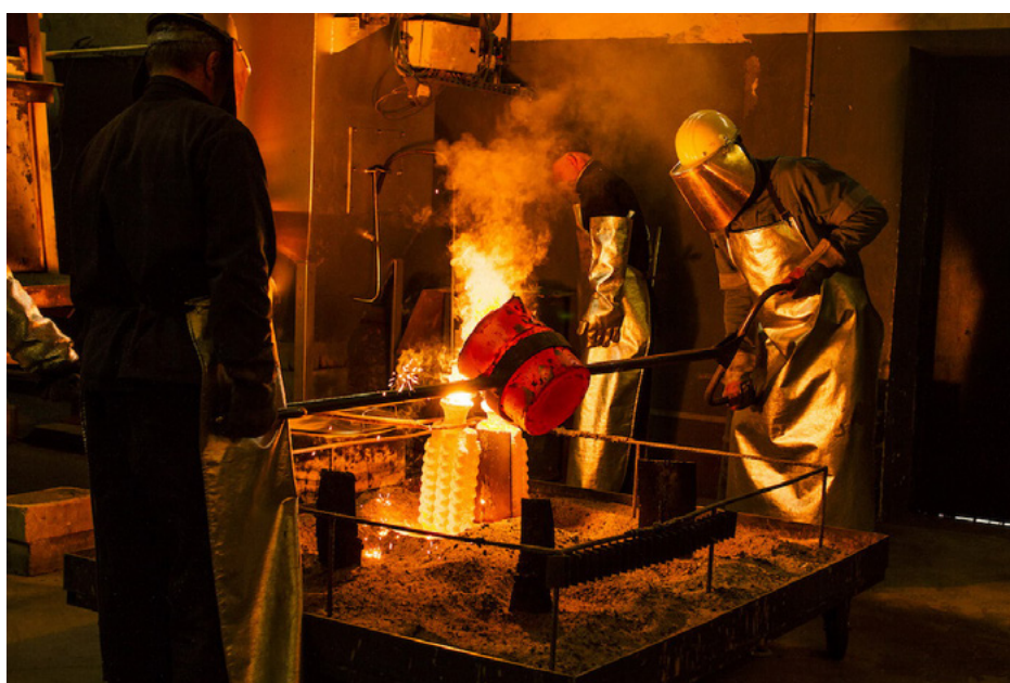
PAC wykonuje własne odlewy precyzyjne m.in. komór gazowych, kurków, suwadeł, czy podstaw muszek, co znacznie zmniejsza koszt produkcji seryjnej broni / Zdjęcie: PAC
