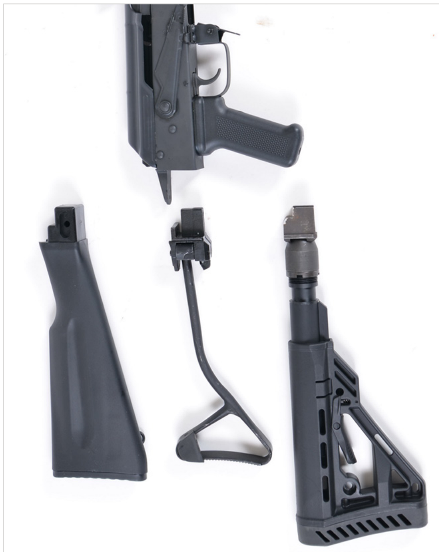
Wszystkie trzy kolby, wykorzystane podczas testu Hellpupa. Najlepsza, ale jednocześnie najdroższa jest oczywiście teleskopowa TDI Arms TRX, wymaga też zakupu adaptera-obsady
