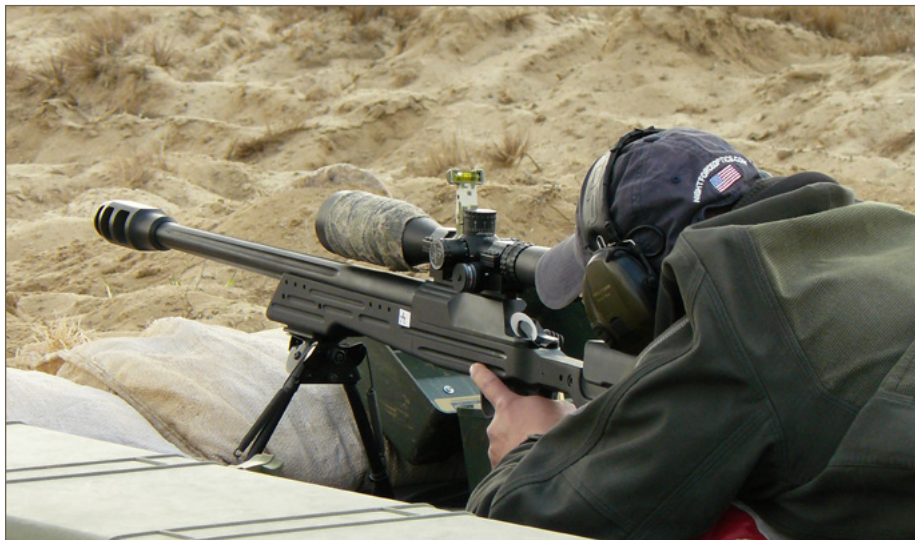
Karabin zaliczany do klasy Magnum, czyli takiej, w której energia wylotowa pocisku jest wyższa od 4500 J
