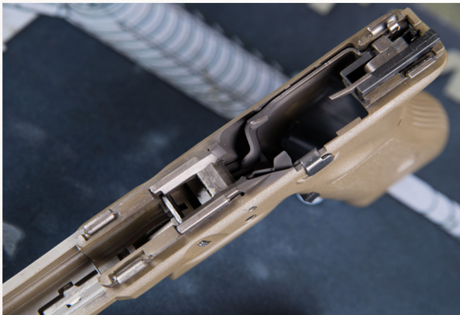
Glock 17 po wystrzeleniu ok. 200 szt. amunicji. Na zbliżeniu wyraźnie widać nagar zarówno na elementach metalowych, jak i kompozytowym szkielecie pistoletu (w tym w gnieździe magazynka)
