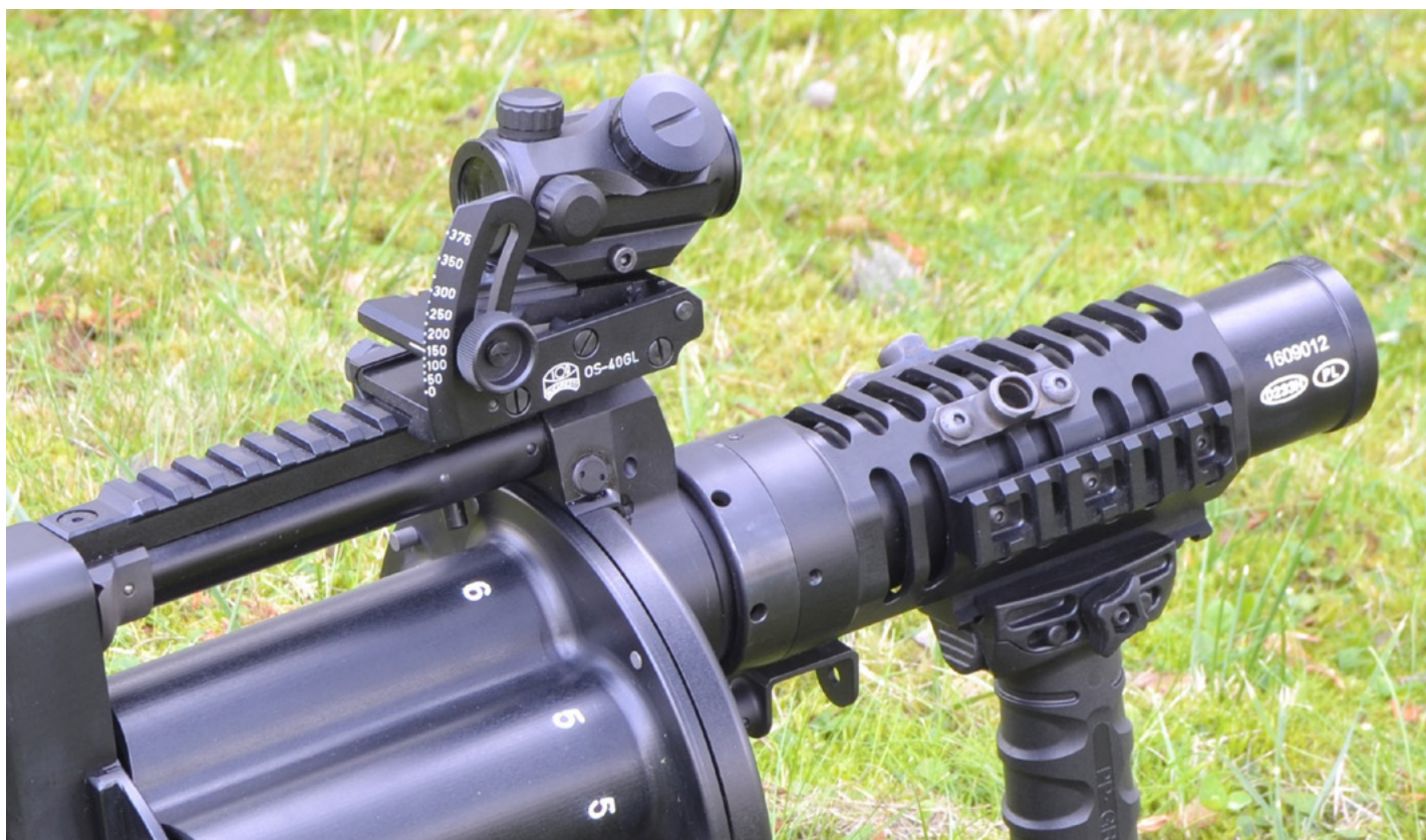
RGP-40 kompletowany jest z zasadniczym celownikiem kolimatorowym, rumuńskim IOR Valdada OS-40GL. Na uchylnej podstawie można jednak mocować i inne kolimatory
