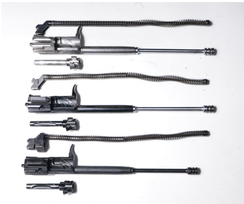
Suwadło Hellpupa (na dole) jest nieznacznie krótsze od typowego z AK i AKM, o długość pręta tłoka. Pozostałe wymiary i zamki pozostają te same. Suwadło i zamek są w Hellpupie azotowane
