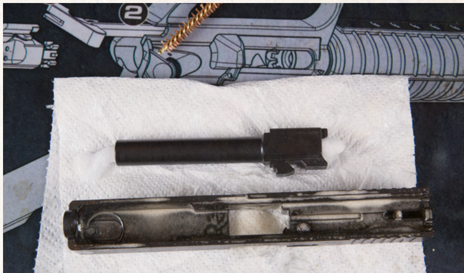
Lufa wraz z komorą naboju i zamek Glocka potraktowane odpowiednio pianką oraz środkiem czyszczącym
