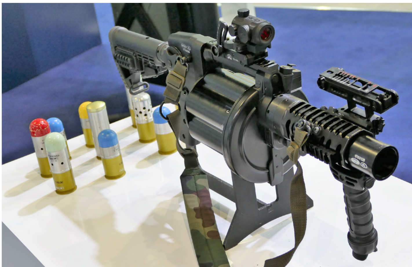
RGP-40 z tegorocznej serii produkcyjnej, pokazany na targach Pro Defense w Ostródzie. Dobrze widoczne białe oznaczenia na celowniku dla amunicji LV i czerwone dla naboju MV
