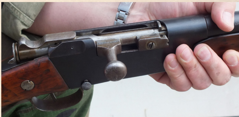
Rączka zamka, która w karabinach Gras stanowiła jedyne ryglowanie, w karabinach Lebel pełniła dodatkową funkcję rygla zapasowego
