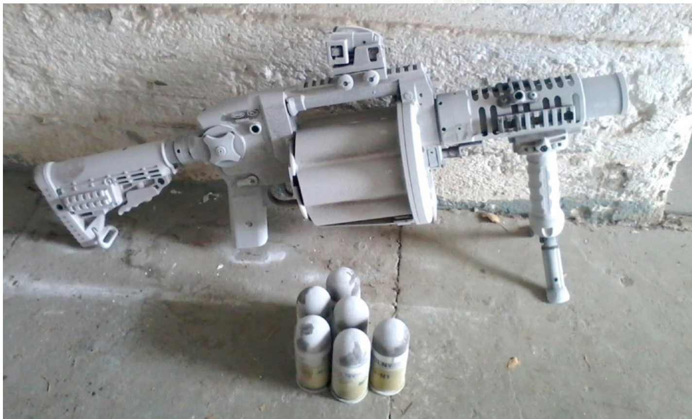
Badanie RGP-40 na zapylenie i zapiaszczenie w temperaturze +55 °C oraz poddanie broni działaniu mieszanki pyłowej
