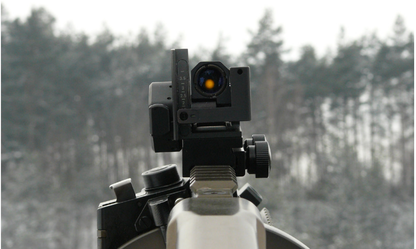
Początkowo do modeli i prototypów używano izraelskiego zamkniętego celownika kolimatorowego Meprolight GLS-203 o pomarańczowym znaku celowniczym
