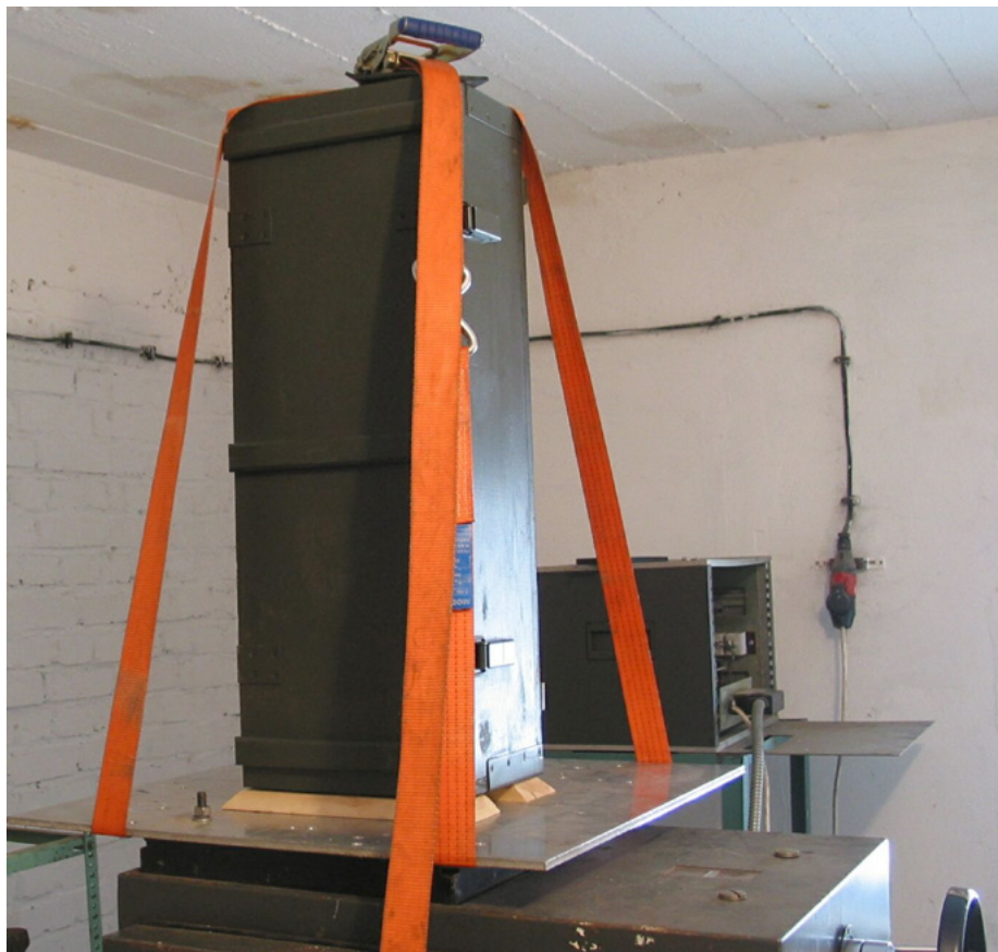
Badanie wytrzymałości granatnika na transport w skrzyni transportowej poddanej wielokrotnym uderom
