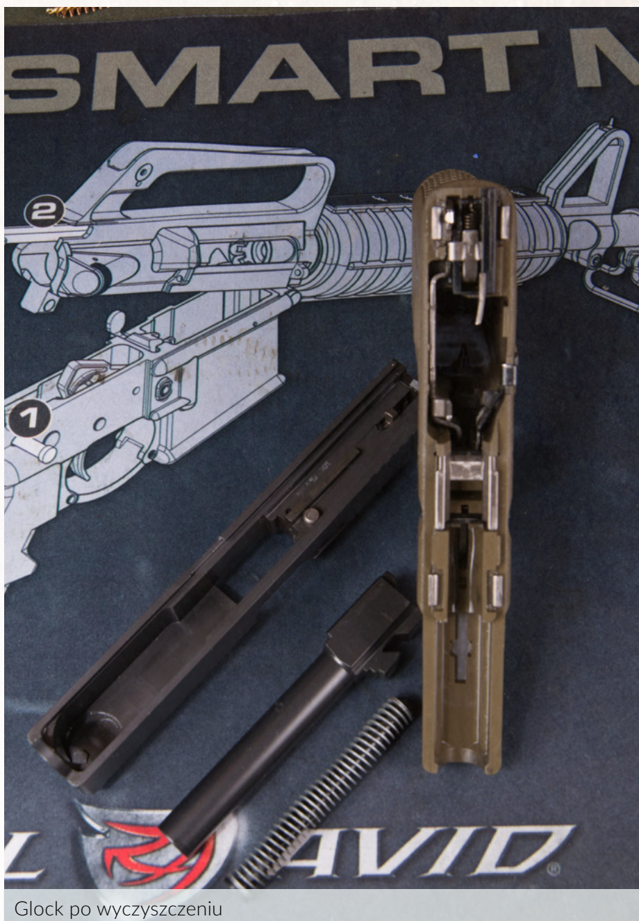
Lufa wraz z komorą naboju i zamek Glocka potraktowane odpowiednio pianką oraz środkiem czyszczącym
